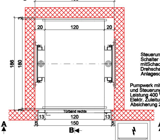
Steuerungskasten Beleuchtung separate Schalter und Steckdose zusammen mit Schachtbeleuchtung. Separater Drehschalter für das Kabinenlicht neben dem Anlageschalter. Anschluss 3 x 1.5 mm²
